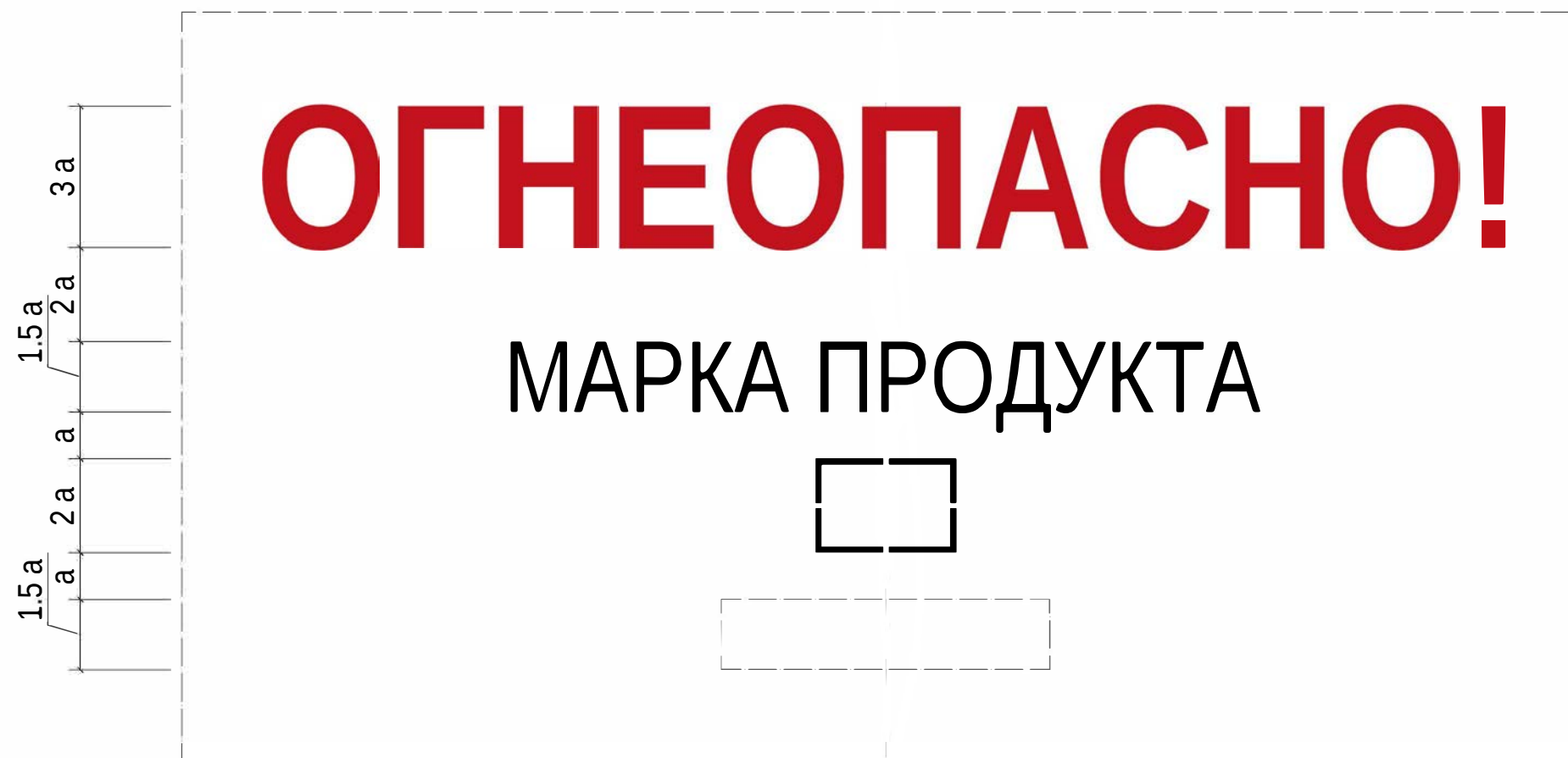
СХЕМА ПОСТРОЕНИЯ ТЕХНОЛОГИЧЕСКОЙ МАРКИРОВКИ НА РЕЗЕРВУАРАХ
