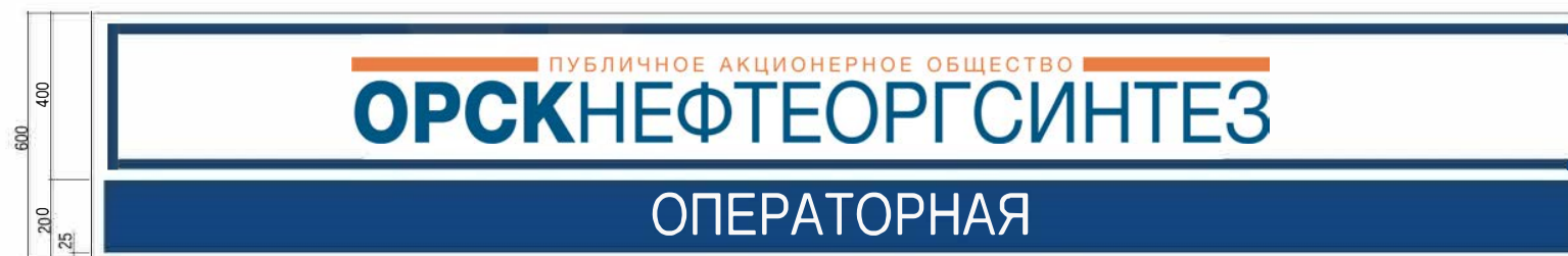
ТИПОВОЕ ОФОРМЛЕНИЕ С МОДУЛЕМ (a) - 600мм; ШРИФТ (Liberatoin Sans Narrow Regular) - 100мм
